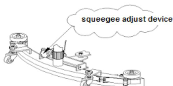
**Когда отклоняются концы лезвия, поверните ручку по часовой стрелке, в случае наклона середины – против.**
