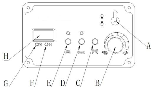
5. Поверните переключатель в положение "↑", и машина будет автоматически двигаться вперёд; в положении "↓" машина будет двигаться назад.
