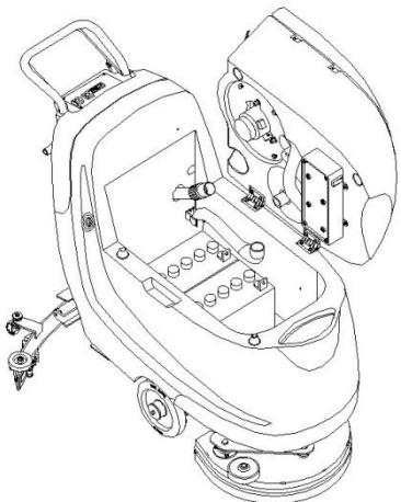
**Внимание: Убедитесь, что вы подключаете КРАСНЫЕ (+) провода к положительным (+) клеммам, а ЧЁРНЫЕ (-) - к отрицательным (-). В случае неправильного подключения, машина не будет работать. Кроме того, неправильное подключение может повредить машину и вызвать взрыв.**
