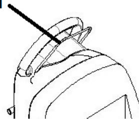
7. Поворачивайте регулятор скорости в сторону "↗", чтобы увеличить скорость машины, в сторону "↘" - чтобы уменьшить её.
